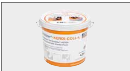
Schlüter®-KERDI-COLL-L je dvousložkové těsnící lepidlo na bázi akrylátové disperze (bez rozpouštědel) a cementového reaktivního prášku. Je vhodné pro lepení a utěsnění spojů pásů Schlüter-KERDI překlátováním a spojů na sraz.
